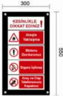
Kolon üzeri ikaz levhası Alüminyum üzeri folyo uygulama
