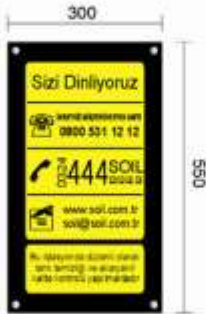
Kolon üzeri iletişim levhası Alüminyum üzeri folyo uygulama
